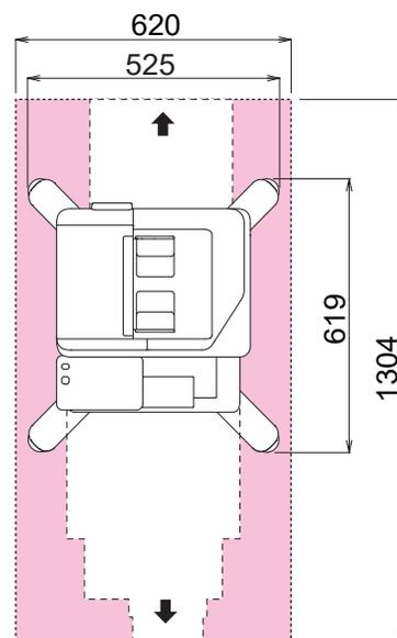
本体 + 専用キャビネット L+4ピン出力装置
