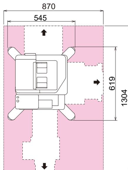
本体 + 専用キャビネット L+4ピン出力装置
