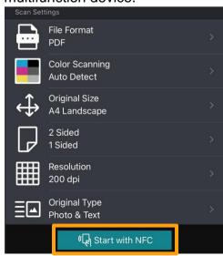
3. 按【從 NFC 開始】, 在點選後顯示畫面的情況下,將行動裝置靠近多功能裝置。
