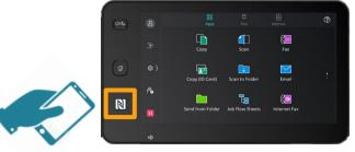
C. 按【NFC】, 然後點選【開始印表機的登記】。在點選後顯示畫面的情況下,將行動裝置靠近多功能裝置。
