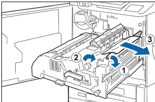
6. 向右拉開拉桿 [2d] (1) · 向右扭動 [2c] (2) · 清除卡住的紙張 (3)。
