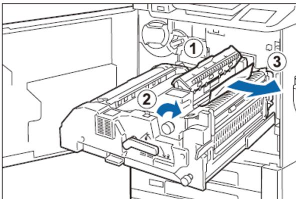
5. 拉開拉桿 [2b] (1) · 向右扭動 [2c] (2) · 清除卡住的紙張 (3)。
