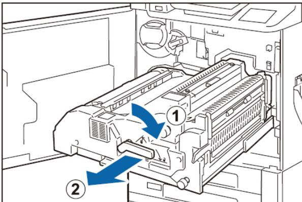
2. 將轉印元件的拉桿 [2] 往右旋轉直到呈水平為止 (①)，再將轉印元件往前方拉開到停止位置 (②)。
