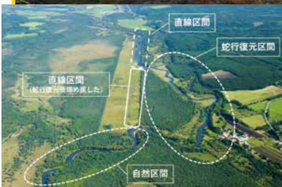
2011年に完成した釧路川本流の再蛇行化（写真提供：北海道開発局）。イトウ等の大型魚がすめる河川環境が復元されつつある
