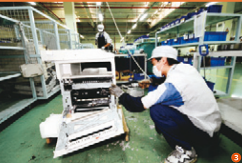
1 2 3 回收后多功能一体机的零部件可再利用技术，是富士施乐资源循环系统（照片是富士施乐爱科制造(苏州)有限公司的工作场景）的基础。
