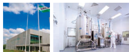
FUJIFILM Diosynth Biotechnologies拥有的高端生物技术,利用了动物细胞和微生物高效生产用于生物药物的蛋白质,还拥有从培养到提取直至精制工序的管理专有技术等。上图是该公司的新生产大楼和追加引进的2000升动物细胞培养罐
