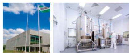
動物細胞や微生物を利用してバイオ医薬品に使用されるタンパク質を効率的に産生する高度なバイオテクノロジーや、培養から抽出、精製にいたるプロセスの管理ノウハウを持つFUJIFILM Diosynth Biotechnologiesの新生産棟と導入する2,000リットルの動物細胞培養タンク
