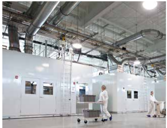
高度封じ込め技術により安全な生産体制を実現するモバイル・クリーンルーム
