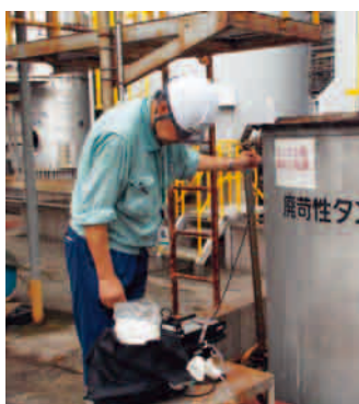
超音波を用いた設備診断
