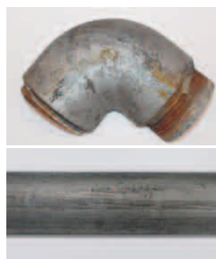
交換した部品例 (外観からはわからないが内部の腐食が進んでいる)
