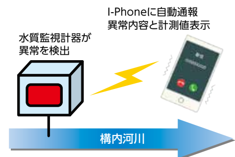
構内河川異常時の自動通報システム
